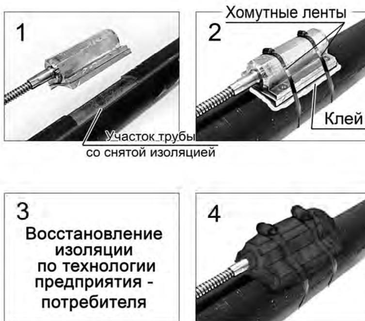
Рисунок 2.5 – Порядок выполнения работ по установке и креплению на трубопроводе ТС подземного исполнения с корпусом типа «К2» с помощью КМЧ
