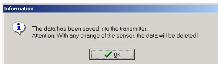
Рисунок Р.16 – Окно «Information» с оповещением о записи коэффициентов коррекции во внутреннюю память ИП.ХТ-W
